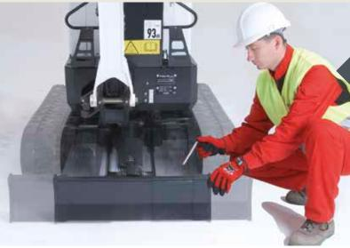
in Serienausrüstung mit einem aus- und einfahrbaren Unterwagen ausgeliefert. Die Schildverlängerungen müssen nicht demontiert und anschließend wieder montiert werden.
